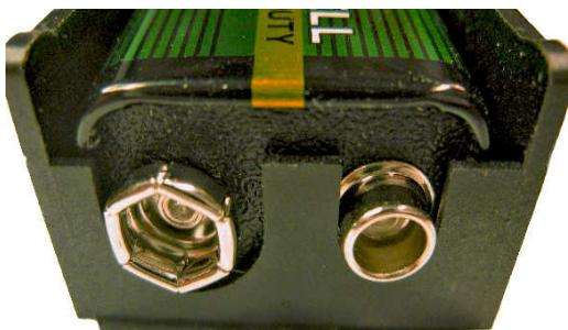
**Isæt batteriet – Vær omhyggelig, og sikr at det sidder korrekt!
