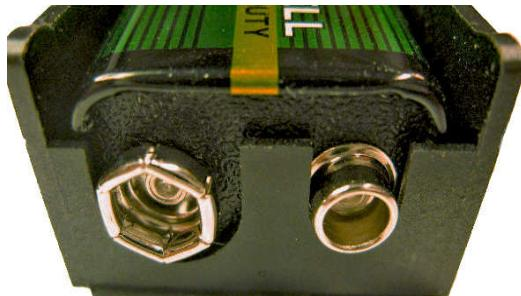
**Placera batteriet rätt i batteridosan! (se bilden ovanför). Ta ut batteriet ur mätaren, om mätaren är oanvänd en längre tid.**
